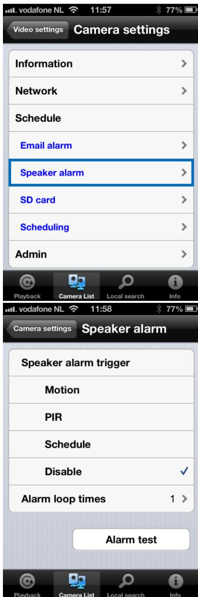
Selecione um acionador do altifalante de alarme e quantos ciclos de alarme. Clique em Teste do alarme para testar o alarme (certifique-se da existência de um altifalante conectado à câmara).
