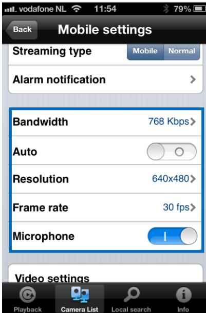
1. Puede ajustar el ancho de banda de 32Kbps a 1,5Mbps.
