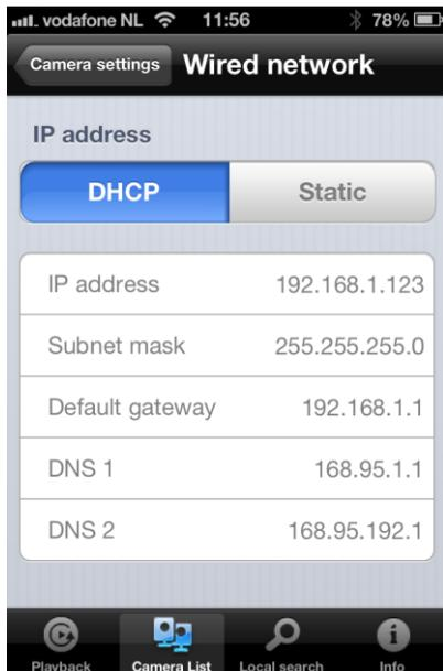
Puede elegir si la cámara utilizará una dirección IP Dinámica (DHCP) o una dirección IP Estática (la configuración predeterminada es DHCP).
