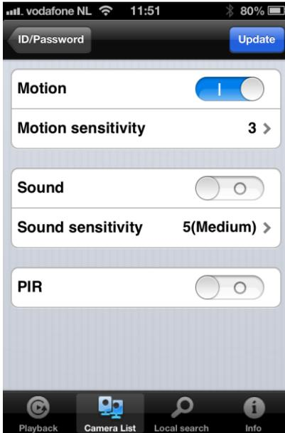
Wählen Sie, was bei Auslösung geschieht und klicken Sie auf Aktualisieren. Wenn der Alarm ausgelöst wird, erhalten Sie eine Alarmbenachrichtigung. Drücken Sie wie in der Abbildung unten gezeigt auf Ansicht, um den Live-Stream inklusive Voraufzeichnungspuffer anzuzeigen (sofern eine SD-Karte eingesetzt ist).
