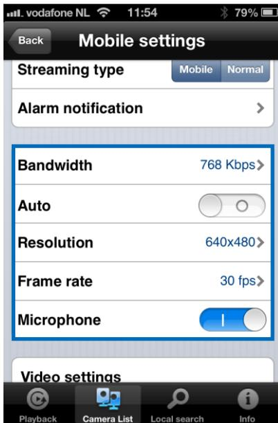
1. Die Bandbreite kann auf Werte zwischen 32 kBit/s und 1,5 MBit/s eingestellt werden.
